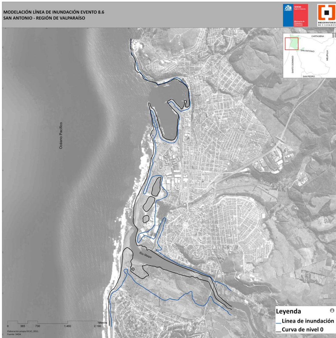
Figura 38: Línea de Inundación para el Tsunami provocado por el escenario de 8.6 Mw. Fuente: Elaboración propia
